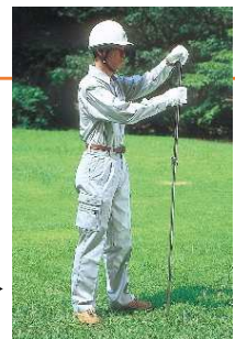
長谷川式大型検土杖(サンプラー) における土色確認状況
