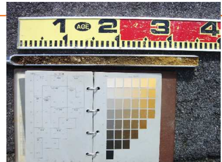
長谷川式大型検土杖(サンプラー) における土色確認状況
